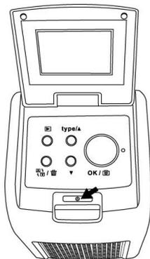
3. Inserire in modo appropriato il telaio col negativo/diapositiva osservando l'indicazione del simbolo ▲ o ● stampigliato sul telaio e sullo scanner.
